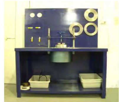
API 682 TEST RIG
